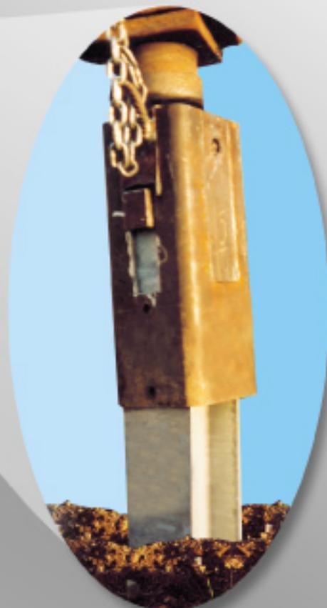
↓ **DISPOSITIVO BATTI PALANCOLE, PUTRELLE O PALI.** detta attrezzatura deve essere applicata ad un martellone idraulico. In funzione del martellone va dimensionato il dispositivo di guida e di battuta. Può infiggere profilati per gard-rail.
