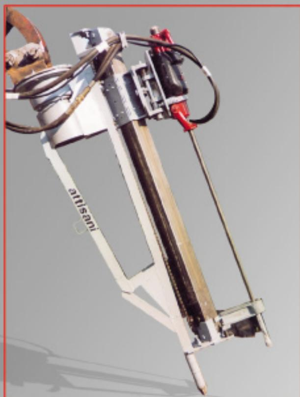
↓ **PERFORATRICE UNIVERSALE** da montare su braccio di escavatore, per eseguire fori in qualsiasi direzione. La slitta è predisposta per alloggiare qualsiasi tipo di perforatrice pneumatica. Caratteristica della suddetta slitta è quella di essere impiegata per le realizzazioni di piccole gallerie su roccia o effettuare fori in trincee per alloggiare dinamite o malta espansiva per facilitare lo sbancamento.
